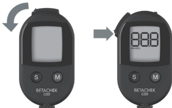
Das Messgerät schaltet sich ein und führt eine numerische Überprüfung des Displays durch. Überprüfen Sie, ob alle Segmente korrekt funktionieren, wie unten gezeigt.
