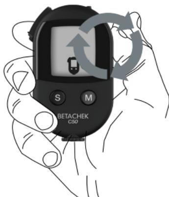
Das Messgerät zeigt mit einer absteigenden Anzahl an Segmenten an, wie lange es dauert, bis der Test in Position ist. **Verlangsamten Sie die Drehung, wenn nur noch ein Segment übrig ist.**
