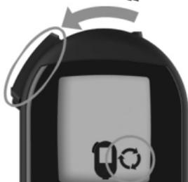
**4** Daumenrad drehen bis Testbereich in Position ist und Display "OK" anzeigt.
