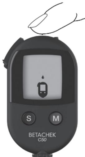
Wenn ein Blutstropfen aufgetragen wurde, ertönt auf dem Messgerät ein Signalton (sofern eingeschaltet) und die Messung beginnt.
