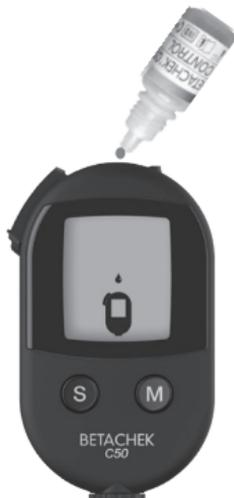
**Achtung:** Die Testzone erfordert eine geringe Menge an Kontrolllösung. Um das Verschütten von Kontrolllösung über den Sensorbereich zu vermeiden, üben Sie das Ausdrücken eines kleinen Tropfens vom Messgerät entfernt.
