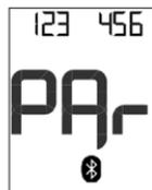
8. Die Übertragung der Messwerte beginnt sobald Sie das Gerät ausschalten bzw. es sich automatisch ausgeschaltet hat, der Messwertspeicher aufgerufen wird oder Sie den Teststreifen herausgezogen haben. Während der Übertragung blinkt das *Bluetooth*®-Symbol
