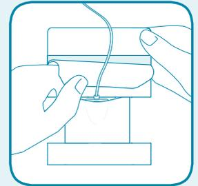
Entfernen Sie oben die untere silikonbeschichtete Schutzfolie und fixieren OPERCAT an der richtigen Stelle.
