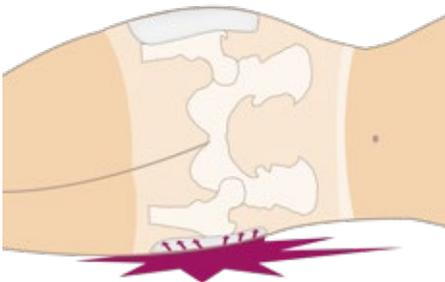
Direkt nach Aufhebung der Belastung kehrt der Protektor, der aus viscoelastischem Weich-Schaum besteht, in seinen Ursprungszustand zurück und schützt sofort wieder.
