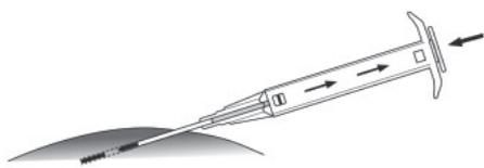
8. Ziehen Sie die Nadel heraus. Um sicherzustellen, dass das Implantat injiziert wurde, prüfen Sie, ob die weiße Kolbenspitze an der Nadelspitze sichtbar ist.
