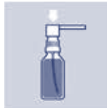
Nun Pumpkopf auf den freiliegenden Teil der Pumpvorrichtung aufsetzen und festdrücken. Vorsicht: Nicht verkanten!
