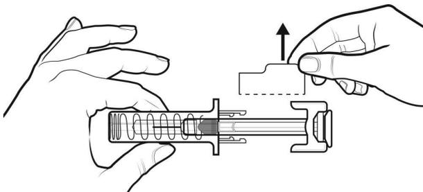
Drehen Sie den Spritzenkolben, um das Etikett in eine Position zu bringen, in der Sie das Etikett der Spritze entfernen können.
