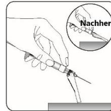
**Sichern der Nadel in der Schutzvorrichtung**
